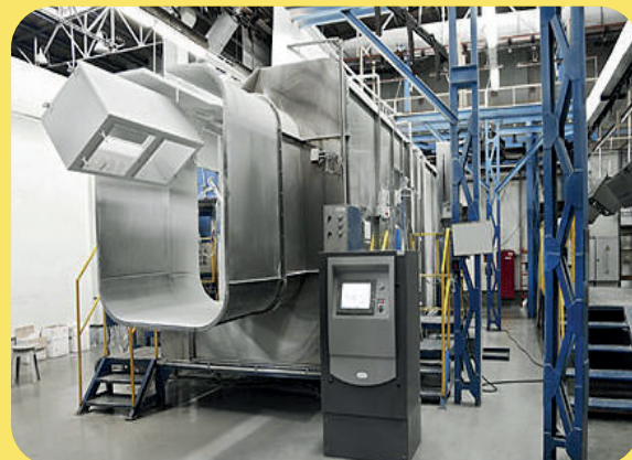
Lubrification de roulements de convoyeurs Peinture époxy poudre, polymérisation flash à 230 °C
